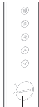
Compartiment à pile de secours
